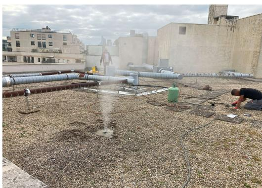
Réalisation de 3 tests fumigène, aucune sortie de fumée n'a été constaté.
