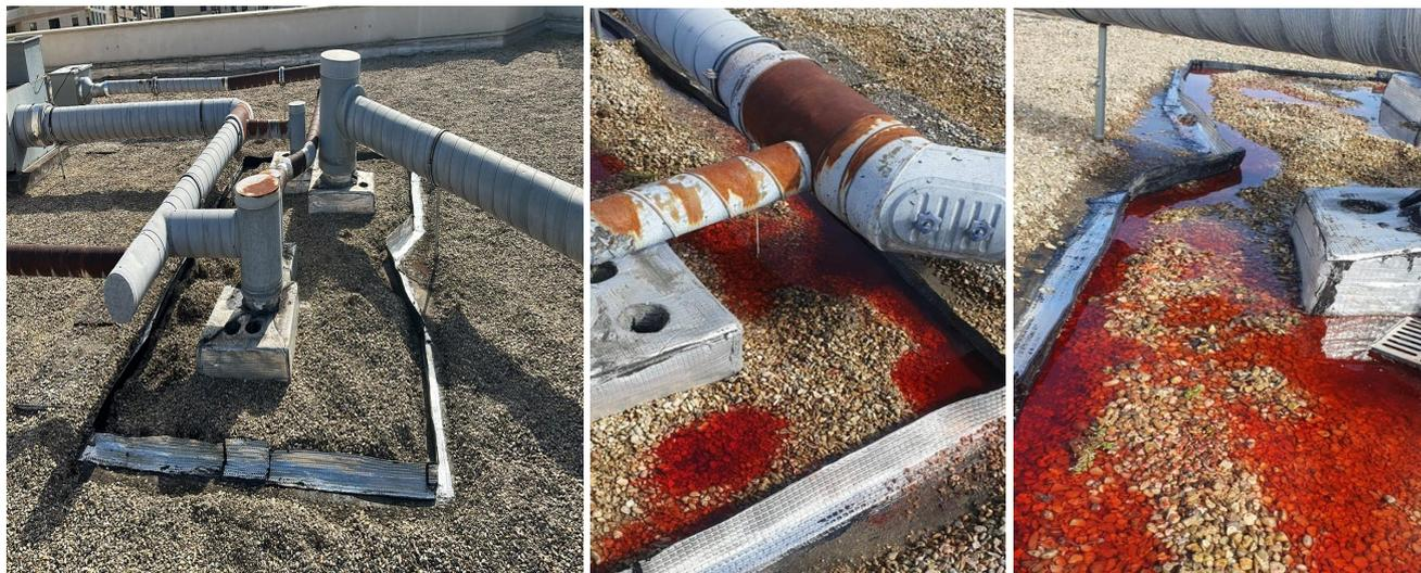
Réalisation d'un batardeau et d'une mise en eau colorée au droit des gaines VMC.
